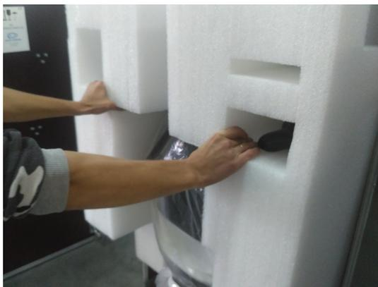
9. Снять два элемента ложемента с робота, аккуратно потянув их в стороны
