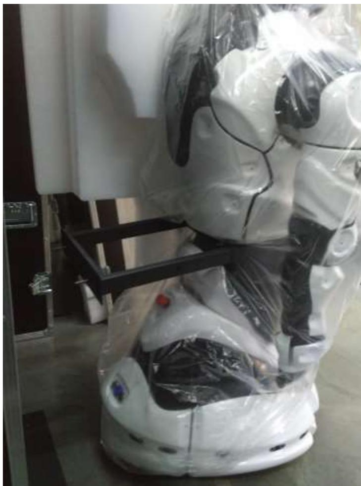
При получении робота необходимо убедиться в том, что кофр перемещался в соответствии с требованиями (вертикально в соответствии с обозначением на наклейке или горизонтально на колесах), визуально оценить целостность кофра. Распаковку следует производить с помощником!
