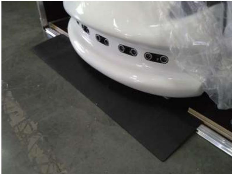
8. удерживая робота за ложемент или за "талию", аккуратно выкатить его из кофра вместе с ложементом и фиксирующей скобой
