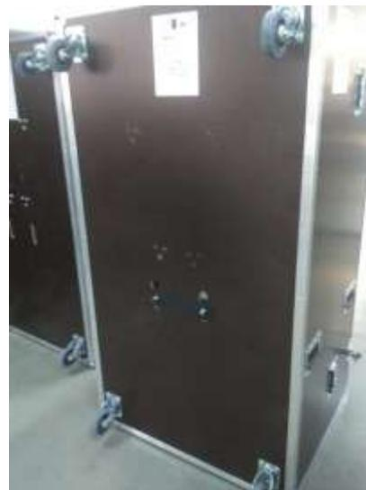
3. Перемещать робота можно или строго вертикально в соответствии с маркировкой на наклейке или горизонтально на колесах
