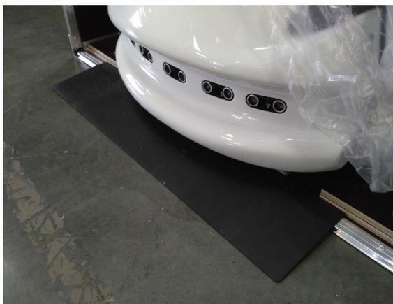
8. Удерживая робота за ложемент или за "талию", аккуратно выкатить его из кофра вместе с ложементом и фиксирующей скобой
