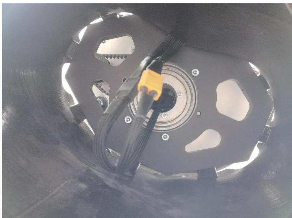
Рис. 18. Подсоединение кабелей питания к торсу робота.
