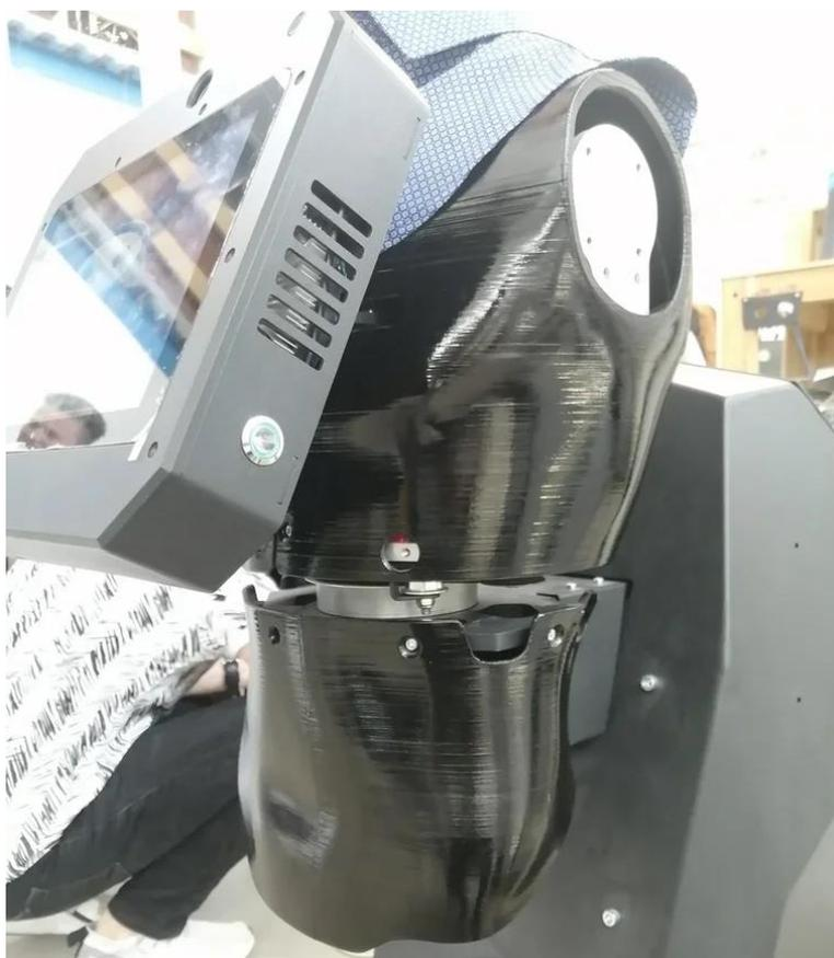
Рис. 17. Корпус робота, закрепленный на платформе.
