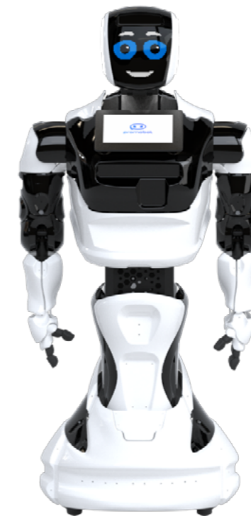
Рисунок 2.6. Руки-манипуляторы в нулевой позиции
